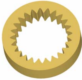
圖 1 內齒輪外觀示意圖
